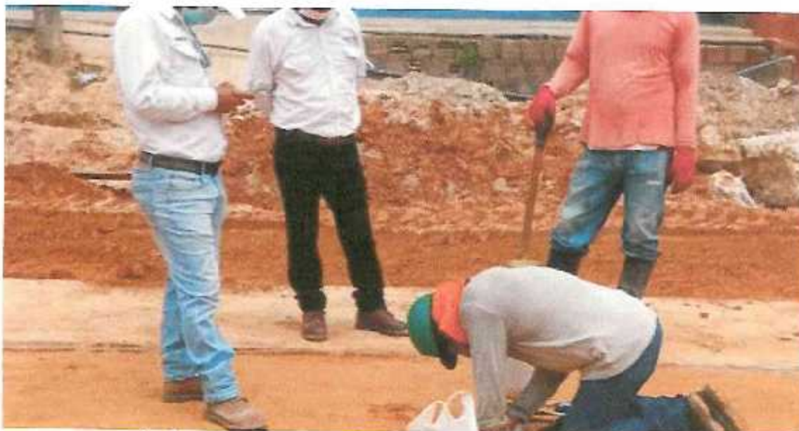
FOTOGRAFÍA 08: SE CONTINUA CON LA PRUEBA DE DENSIDAD DE CAMPO DEL MATERIAL DE PRÉSTAMO (A-2-4) EN LA CA. URARINAS.
