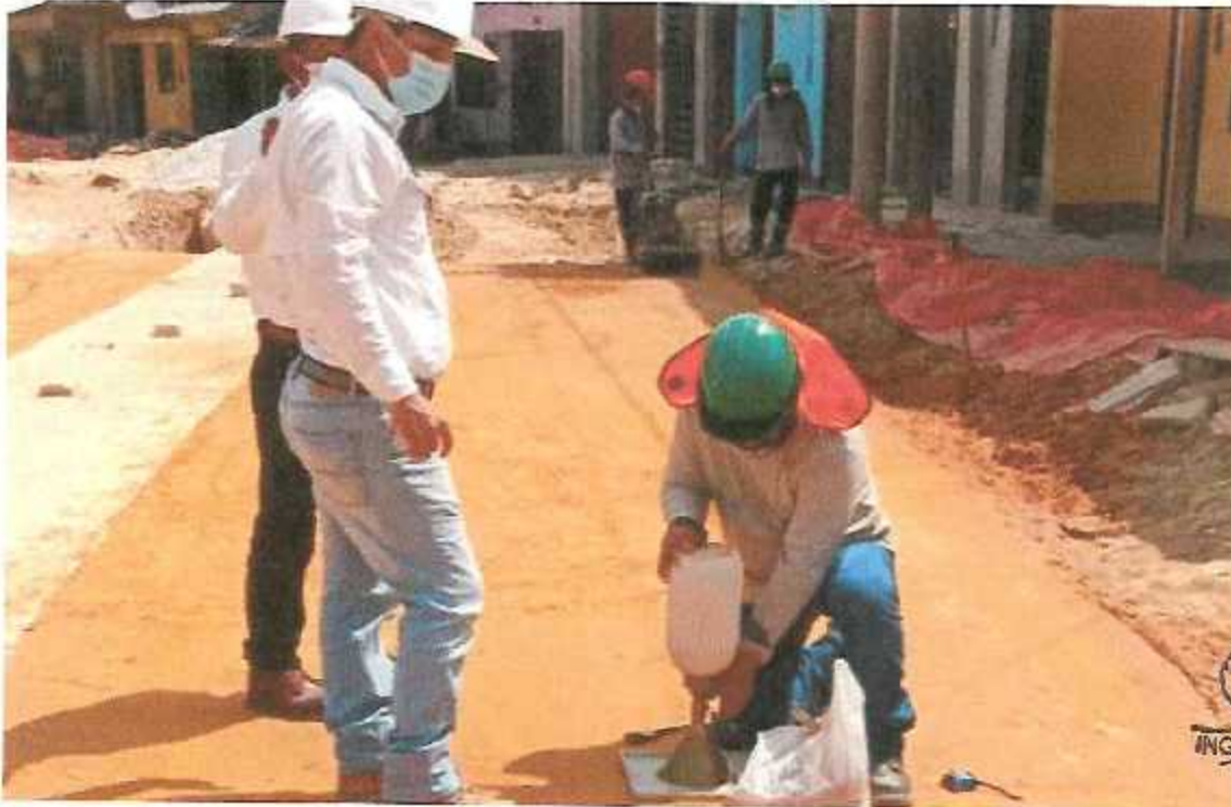
FOTOGRAFÍA 08: SE CONTINUA CON LA PRUEBA DE DENSIDAD DE CAMPO DEL MATERIAL DE PRÉSTAMO (A-2-4) EN LA CA. URARINAS.
